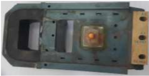
Fig.16.Output contactor (CM) ၏ချို့ယွင်းနေသော coil
