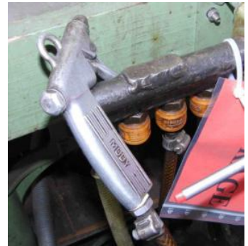
ပုံ ၈-၆ လေယိုစိမ့်မှု (leakage) ဖြစ်နေသည့်နေရာများအား အမှတ်အသား(tagged) လုပ်ထားပုံ
