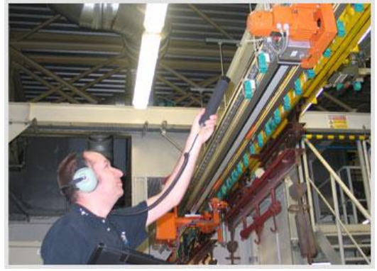
ပုံ ၈-၅ Ultrasonic leak detector ဖြင့် လေယိုစိမ့်သည့်နေရာကိုရှာဖွေနေစဉ်
