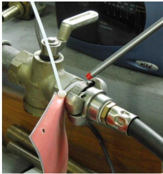
ပုံ ၈-၆ လေယိုစိမ့်မှု (leakage) ဖြစ်နေသည့်နေရာများအား အမှတ်အသား(tagged) လုပ်ထားပုံ
