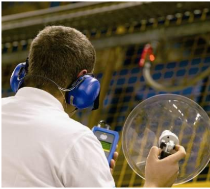
ပုံ ၈-၅ Ultrasonic leak detector ဖြင့် လေယိုစိမ့်သည့်နေရာကိုရှာဖွေနေစဉ်
