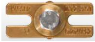
ပုံ ၅-၁၀ Test flange
