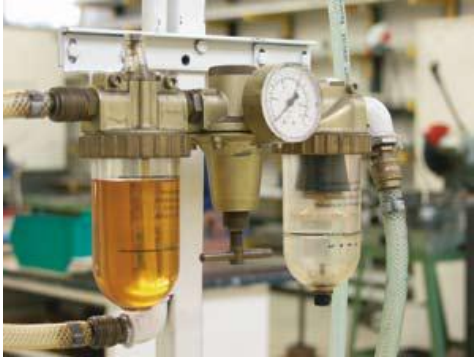
ပုံ ၅-၂ အသုံးပြုသည့်နေရာတွင် pressure regulator နှင့် water separator အတူ တပ်ဆင် ထားပုံ
