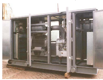
Oil-free screw compressorကို skid ပေါ်တွင် တပ်ဆင်ထားပုံ
