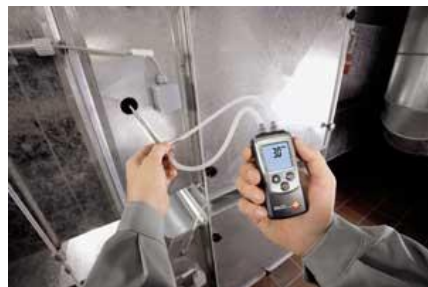
ပုံ ၅-၂၂ Duct test hole မှတဆင့် air flow တိုင်းယူပုံ
