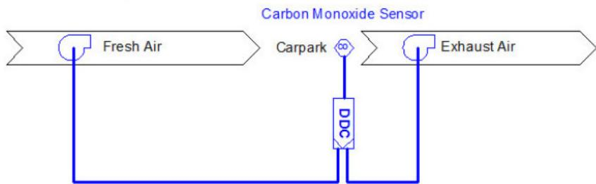
Basement Car Park Monitoring System ၏ အရှိရင်းဆုံး Desing Idea မှာ Basement Car Park အတွင်းတွင် (CO) ခါတ်ငွေ့ Sensor များတပ်ဆင်၍ Supply and Exhaust Fans ကိုလိုအပ်သည့်အခါမှာသာမောင်းခြင်းဖြစ်သည်။
