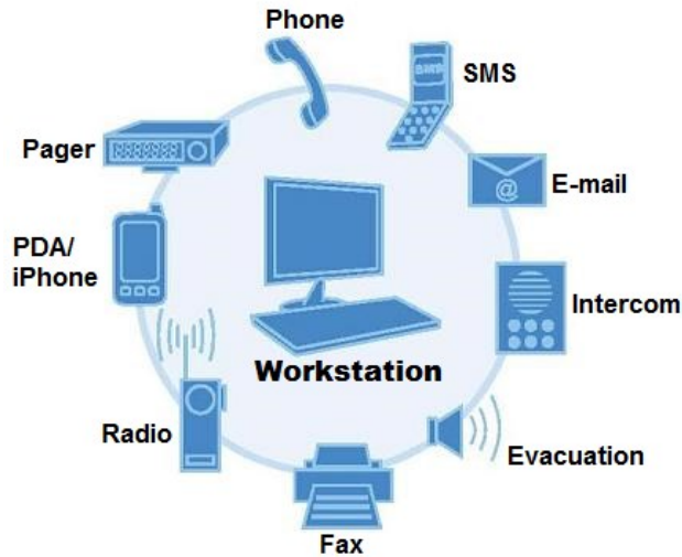
ပုံ ၁၀-၆ Building Automation System တစ်ခုမှ alarm ထုတ်ပေးနိုင်သည့် ကိရိယာများ(devices)
