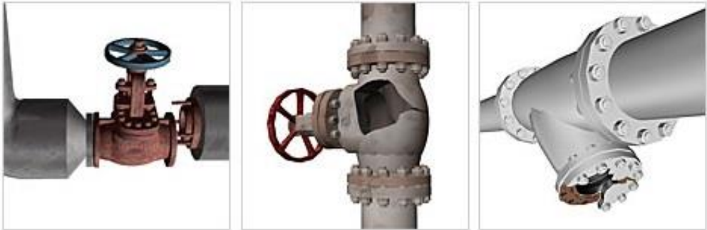
ပုံ ၁-၄ Water hammer ကြောင့် ဘားများ ပျက်စီးပုံ
